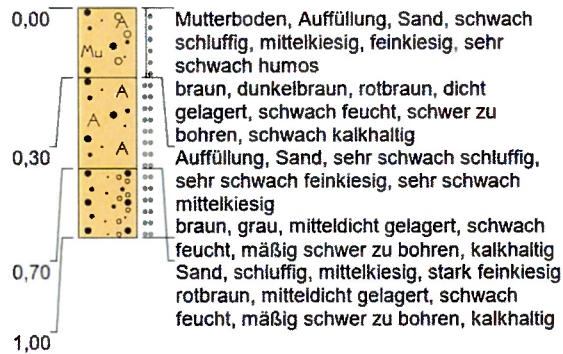
Abbildung 2: Kleinrammbohrung im Bereich der zukünftigen Wohnstraße
