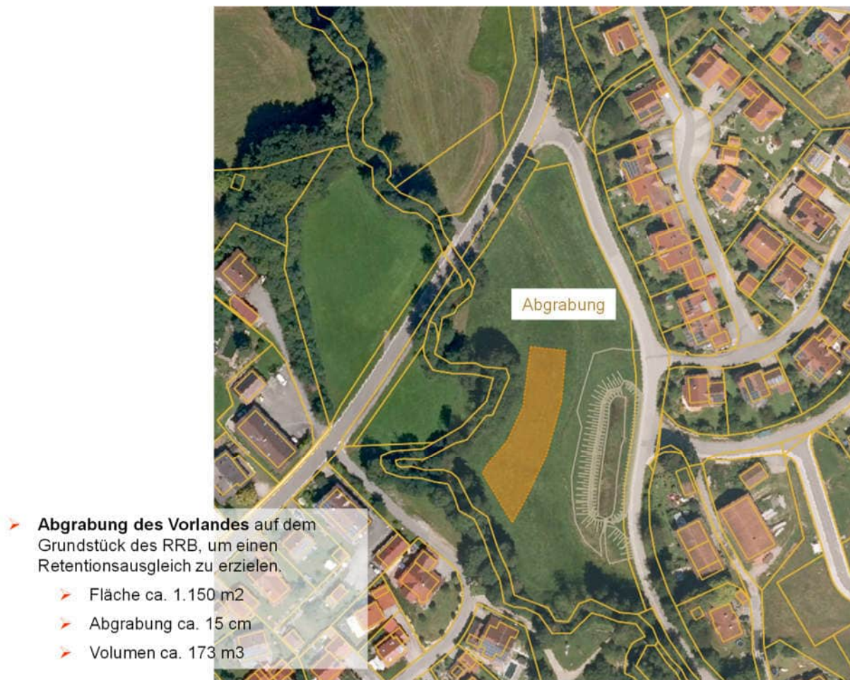
Abgrabung zum Retentionsausgleich
