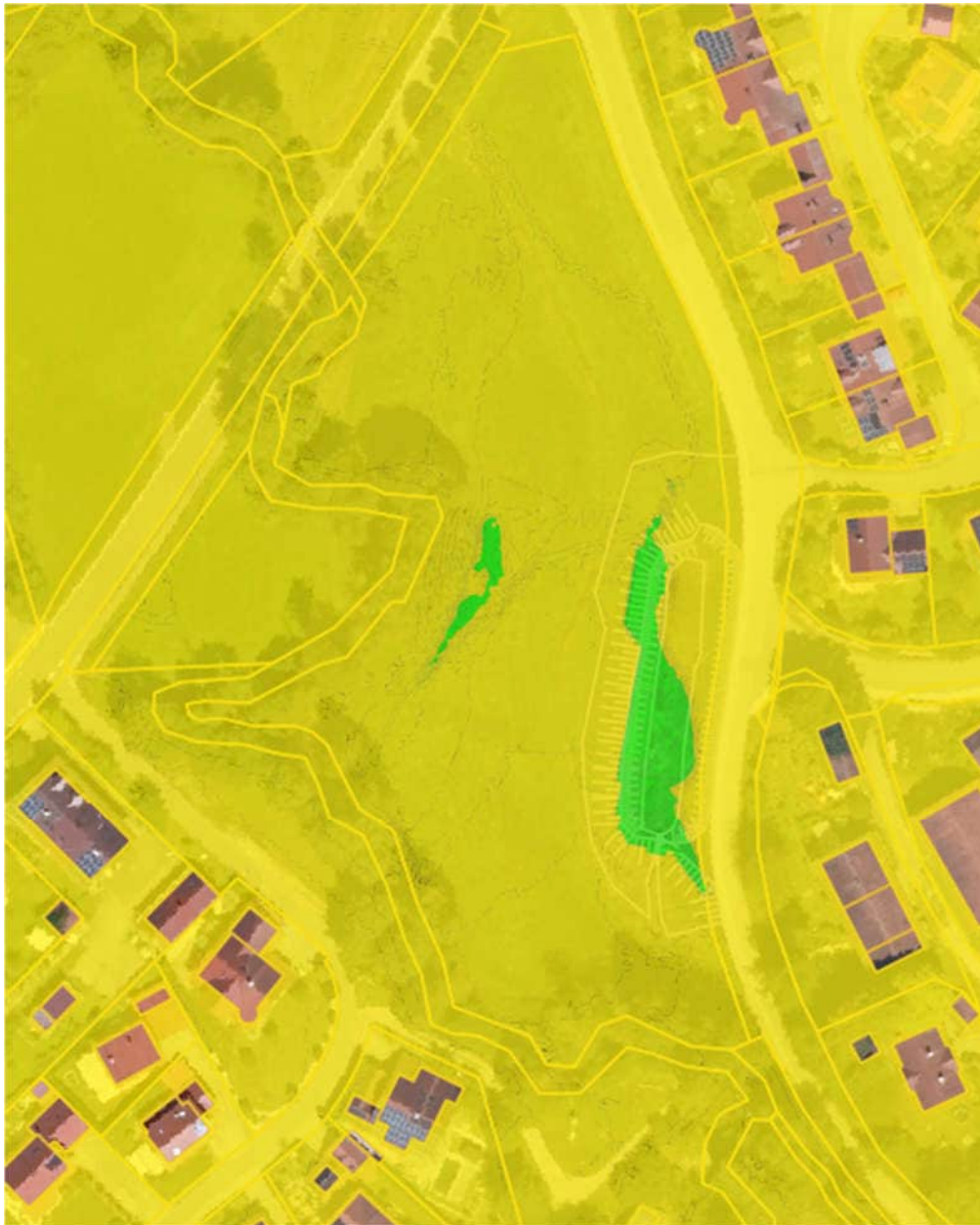
HQ100-Wassertiefenvergleich RRB – Ist
