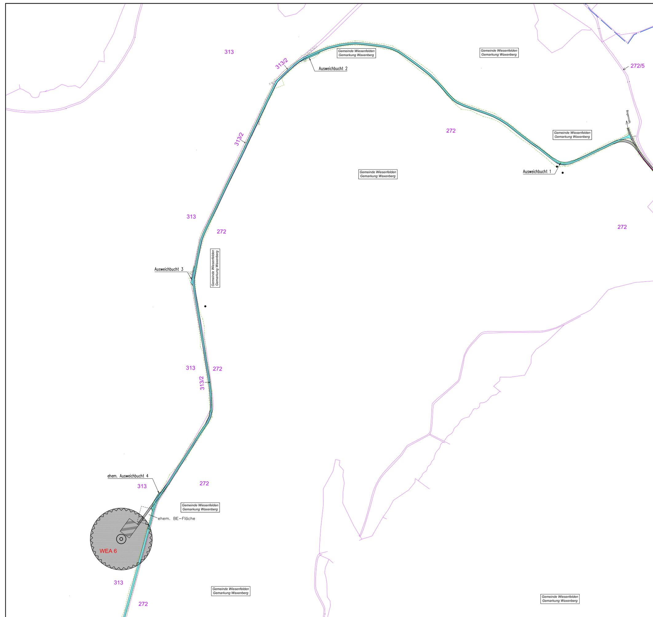
Gemäß Art. 6 (1) BayBO bemisst sich die Tiefe der Abstandsfläche für Windenergieanlagen nach der Gesamthöhe sowie des Abstandes des senkrecht stehenden Rotorblatts zum Mastmittelpunkt (fiktive Außenwand).
